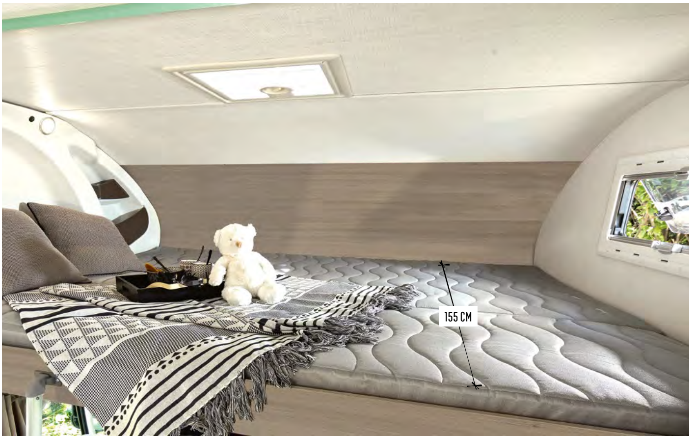
Alkoven - Schlafplatz: 1.55 m breit, Hochklappbares Alkovenbett mit Gasdruckdämpfern und Staunässeschutz
